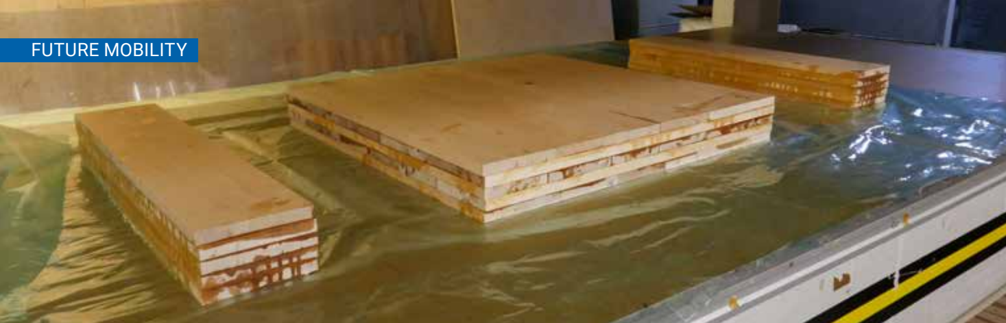
Verklebte und verpresste Holzkerne Bild: TU Graz/Institut für Fahrzeugsicherheit
